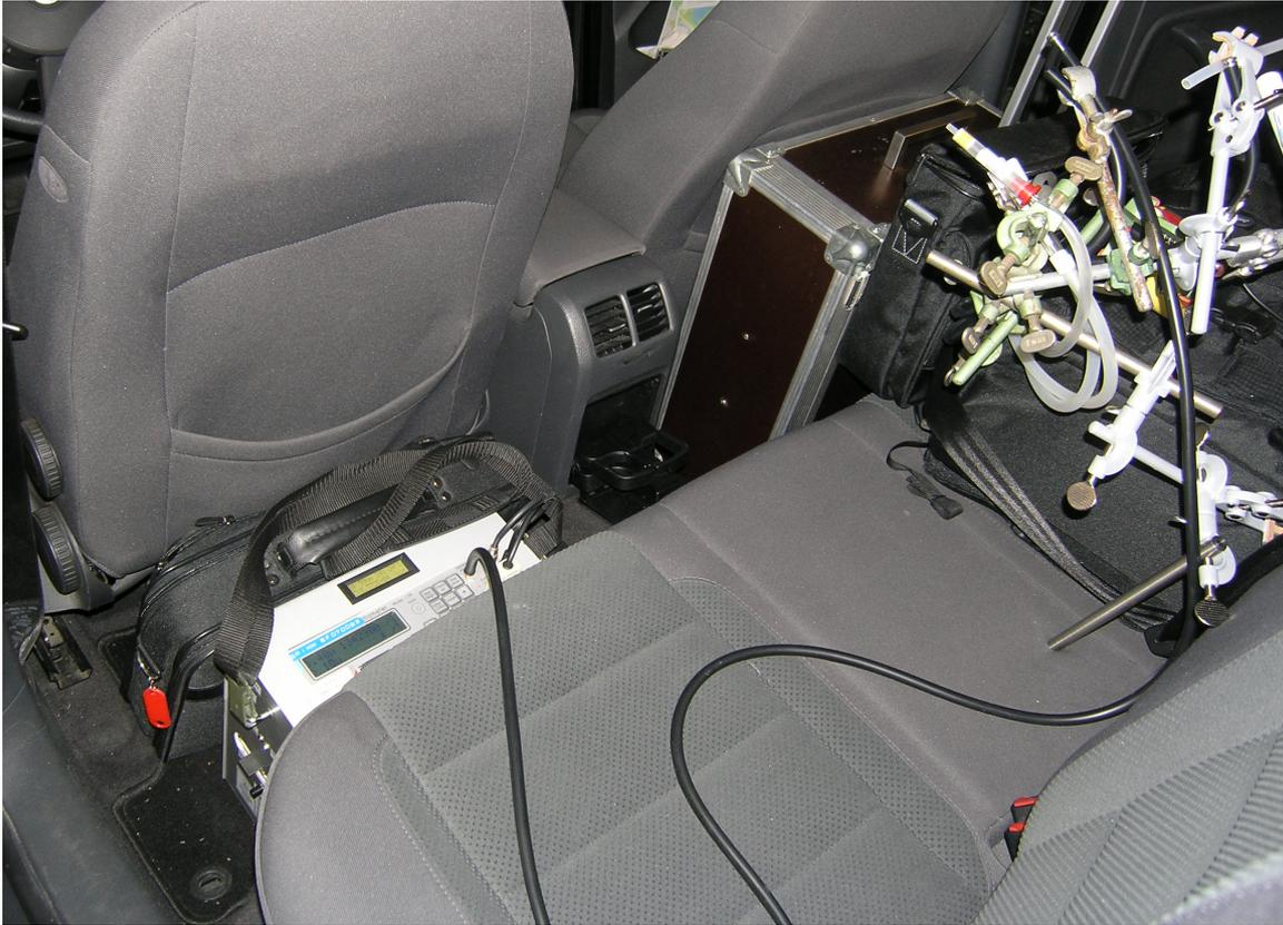
**Abbildung 6:** Die Partikelmessgeräte (Aerosolspektrometer 1.108 mit NanoCheck 1.320) befanden sich während der Messfahrten im Fußraum hinter dem Fahrersitz. Die Raumluft wurde über einen radialsymmetrischen Kopf, der sich in der gemeinsamen Messzone der anderen Instrumente befand, angesaugt und über einen antistatischen Schlauch (schwarz) in die Partikelzähler geführt.
