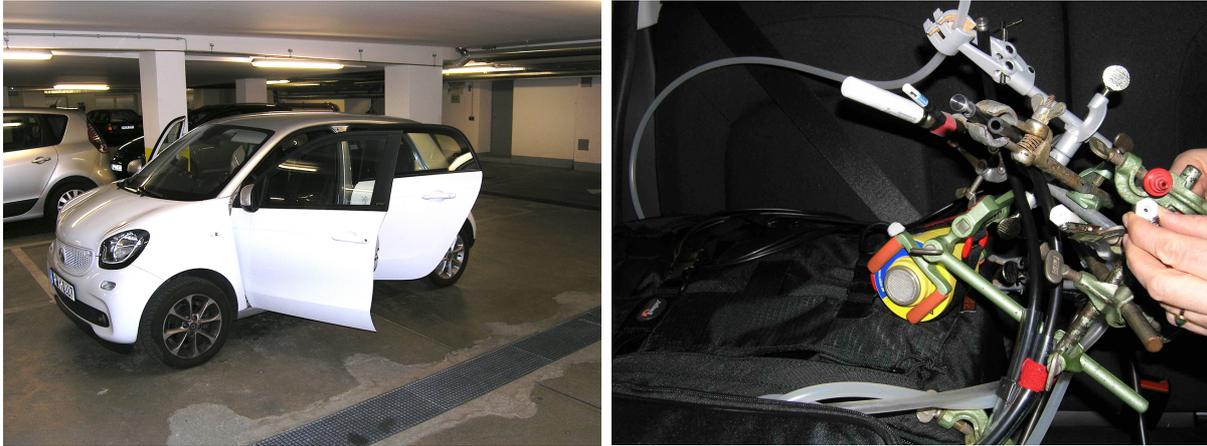
**Abbildung 3:** Die Fahrzeuge wurden zwischen den einzelnen Messfahrten für 10 Minuten stoßgelüftet (links) und die Messgeräte während der Standzeiten für den nächsten Einsatz vorbereitet (rechts: Wechseln der Desorptionsröhrchen zur Bestimmung der flüchtigen organischen Verbindungen).
